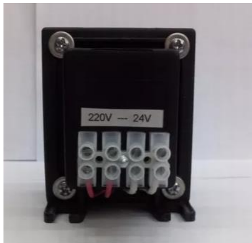
Fig. 32. Transformador 220V-12V de 10 A
