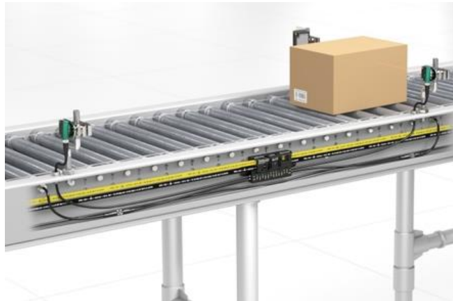
Fig. 20. Transportadores de rodillos con sensores fotoelétricos.
