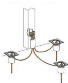
Fig. 17. Esquema de puesta a tierra triple “Pata de ganso”
