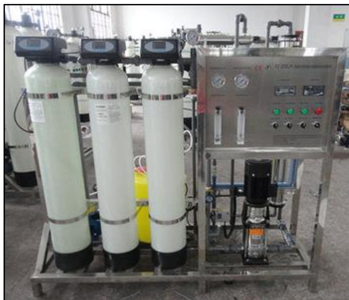
Fig. 11. Destilador por osmosis inversa marca Kyro.
