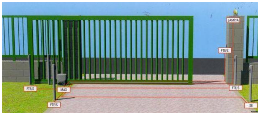
Fig. 30. Portón corredizo automatizado
